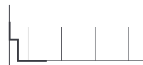
PROFILO DI FINITURA PERIMETRALE A DOPPIA "L" DOUBLE "L" SHAPE PERIMETER PROFILE
